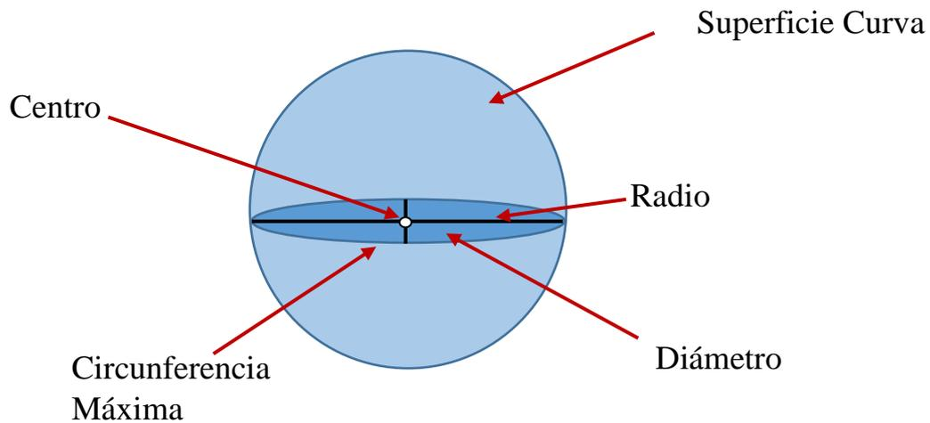
**Cuando un cuerpo geométrico es de revolución: cuando ambos surgen de girar una figura en torno a un eje.**
